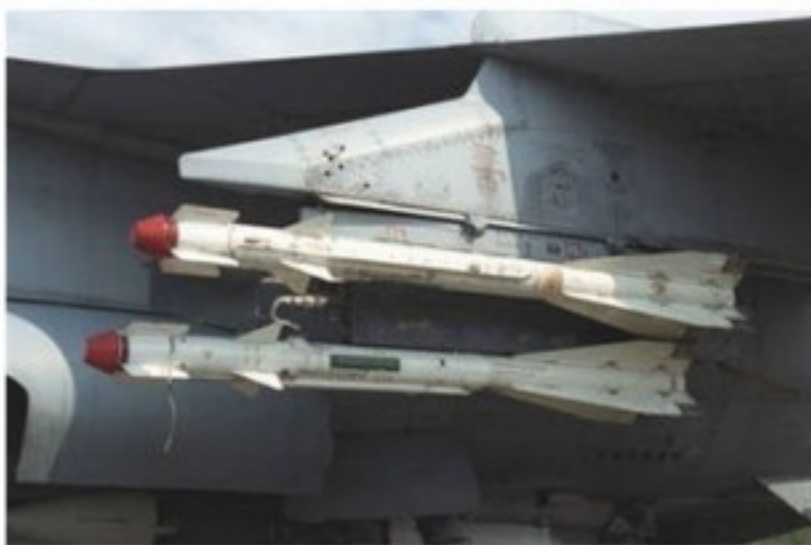
Фото 16. Ракеты Р-60М на внешней подвеске самолета
